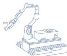
電気信号などを利用して、離れた場所で作業を行う遠隔操作用作業ロボットは、主に人間が作業を行うことが困難な環境下で使用されます。このため、使用される軸受には**高剛性**やコンパクト性が求められます。
