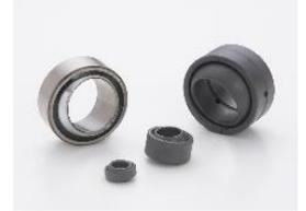
球面滑り軸受は、内外輪を球面接触させた構造で、大きなラジアル荷重と、両方向のアキシアル荷重を同時に負荷できる自動調心形の球面滑り軸受です。給油性球面滑り軸受は、特に交番荷重や衝撃荷重が働く場合に適し、主に産業機械、建設機械などに広く使用されています。
